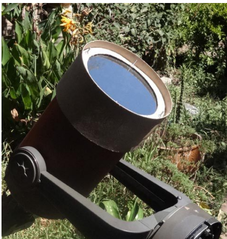
Fig. 4 Uso de un filtro solar adecuado en frente del telescopio, el cual cubre toda la entrada de luz procedente del Sol dejando pasar un ínfima parte de ésta; es una alternativa segura. Es importante notar que no se trata de cualquier tipo de material, no se puede usar negativos, tampoco vidrios ahumados, y otras variantes por el estilo que son extremadamente peligrosas.
