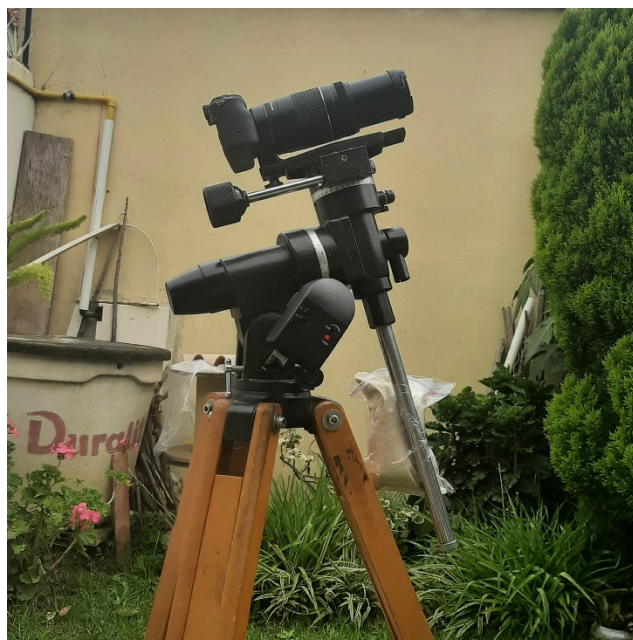
Equipo de fotometría. Una cámara mirrorless con lente de 75-300mm, una improvisada bolsa de arena como contrapeso y el motor de seguimiento acoplado a la montura. El adaptador cámara-telescopio ya está en camino....
