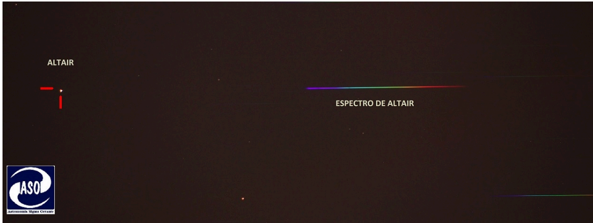
Espectro de la estrella Altair. Tipo de espectroscopía: "Slitless". Elemento de dispersión utilizado: STAR ANALYZER SA-100.
